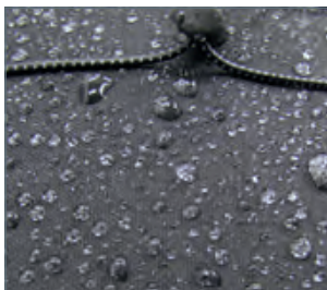
Wasserabweisendes, Fluorcarbon imprägniertes CORDURA®-Gewebe
