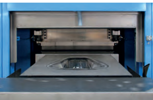
Hydroforming-Anlage mit der Matritze
