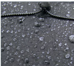
Wasserabweisendes, Fluorcarbon imprägniertes CORDURA®-Gewebe
