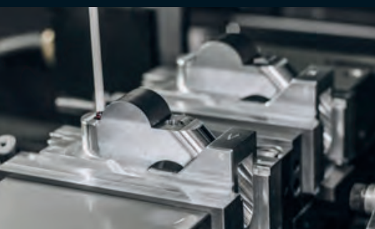
Computergestützte Maßkontrolle mit Rubinstein Spitze
