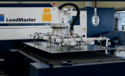
Aufnahme auf dem Tisch des Laserschneidezentrums
