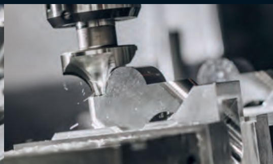
Fräsung des formschlüssigen Sitzes im Unterteil
