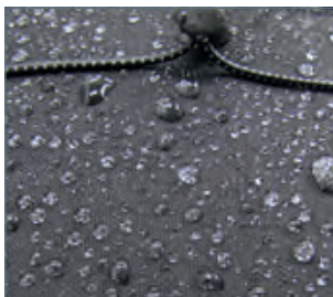
Wasserabweisendes, Fluorcarbon imprägniertes CORDURA®-Gewebe
