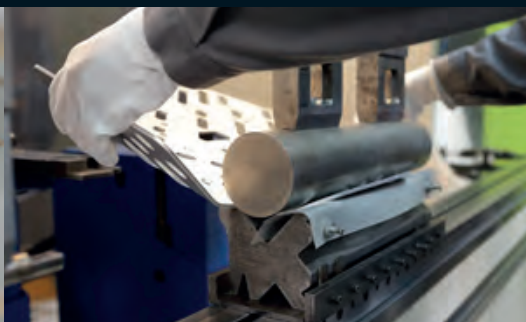
Abkanten, mit viel Erfahrung und Fingerspitzengefühl
