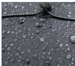
Wasserabweisendes, Fluorcarbon imprägniertes CORDURA®-Gewebe
