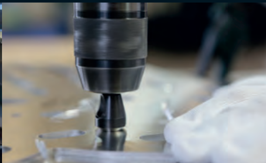
Die Bohrungen werden mit einem Kegelsenker »gesenkt«
