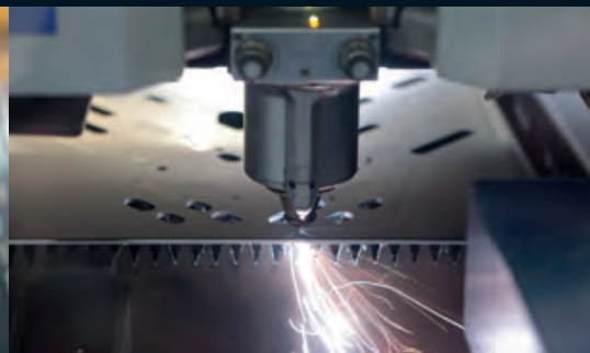
Laser schneidet computergesteuert die Aussparungen
