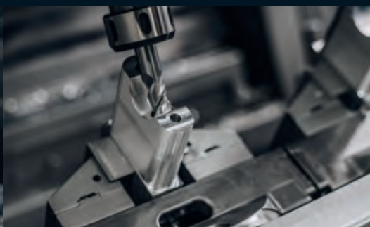
Bohroperation im Unterteil der Lenkererhöhung
