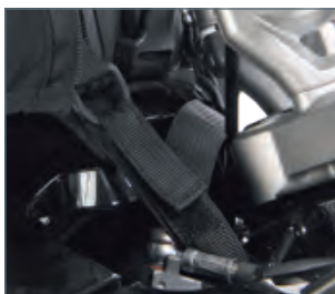
Zusatzbefestigungen vorne für Offroad/schwere Beladung
