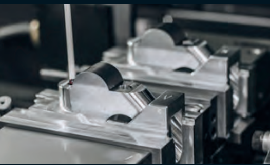
Computergestützte Maßkontrolle mit Rubinstein Spitze
