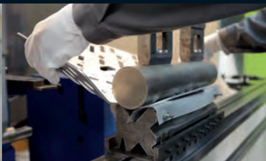
Abkanten, mit viel Erfahrung und Fingerspitzengefühl
