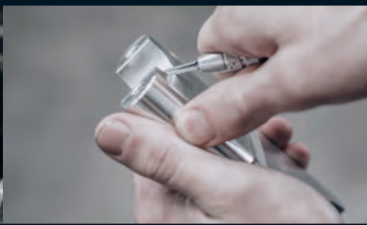
Die Kanten werden vom Werkzeugmacher gebrochen
