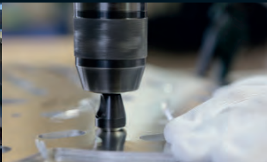
Die Bohrungen werden mit einem Kegelsenker »gesenkt«
