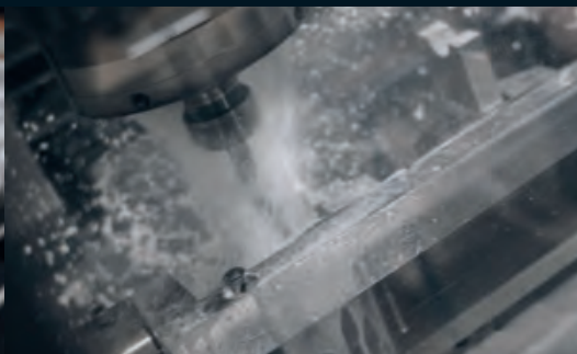
Fräsprozess, als Vorbereitung der Präzisionsbearbeitung
