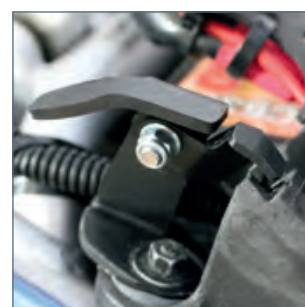
Mit Zusatzschiene, falls Original-Einführung abgebrochen ist
