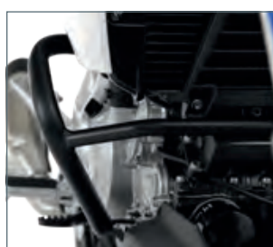
Schutz für Motor und Teile der Verkleidung
