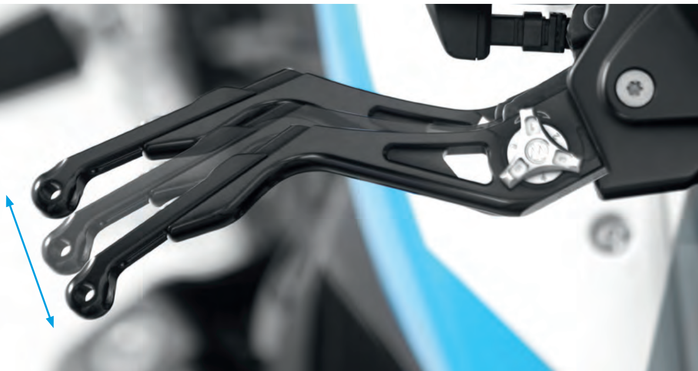
Grifflänge (Abb. oben) und Griffweite (Abb. unten) individuell einstellbar
