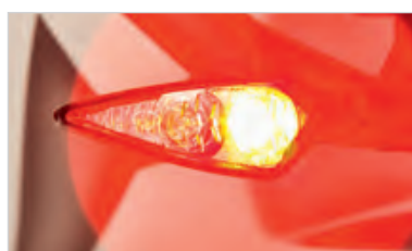
Kellermann Blinker »Micro-Rhombus-DF« mit integrierter Brems-/Rücklicht- und Blinkfunktion – ECE-geprüft
