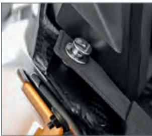
Befestigung mittels LOXX-Knopf und Zahn-Klett
