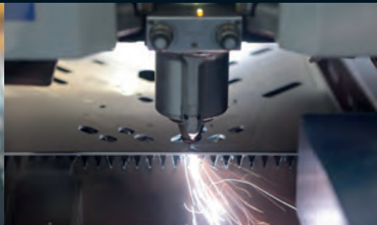
Laser schneidet computergesteuert die Aussparungen
