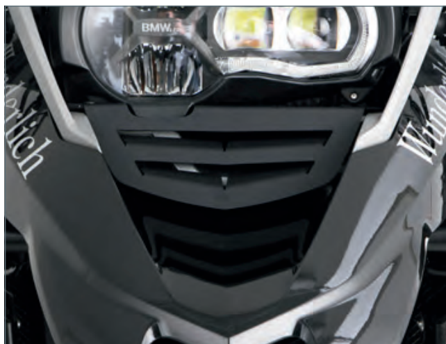
Schützt die Bauteile vor Steinschlägen und Fremdkörpern
