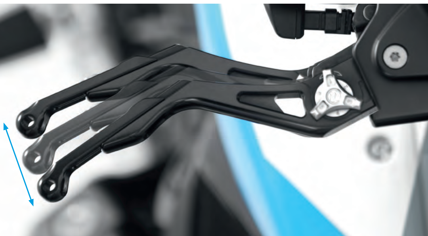
Grifflänge (Abb. oben) und Griffweite (Abb. unten) individuell einstellbar
