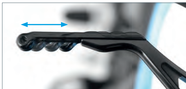
Grifflänge (Abb. oben) und Griffweite (Abb. unten) individuell einstellbar
