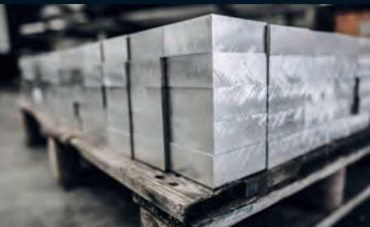
Aluminium-Barren zur Herstellung der Lenkererhöhung
