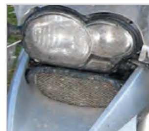
VA-Gitter (geschweißt) oder Wabengitter die Steinschlag und Fremdkörper abhalten, die besonders zerstörerisch auf den Kühler einwirken.
