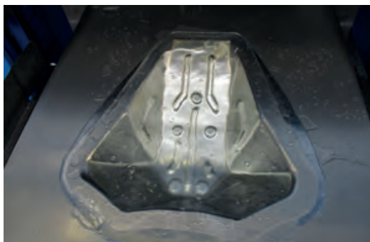
... geformte Motorschutz in der Matrize
